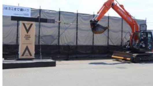
「一般的な耐力壁 6 枚」（写真左・左側）と「トリプルストロングウォール 1 枚」（写真左・右側）の 2 種類の試験体をそれぞれの壁が破壊されるまで重機で水平方向に引っ張り強度を比較
