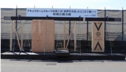
「一般的な耐力壁 6 枚」（写真左・左側）と「トリプルストロングウォール 1 枚」（写真左・右側）の 2 種類の試験体をそれぞれの壁が破壊されるまで重機で水平方向に引っ張り強度を比較
