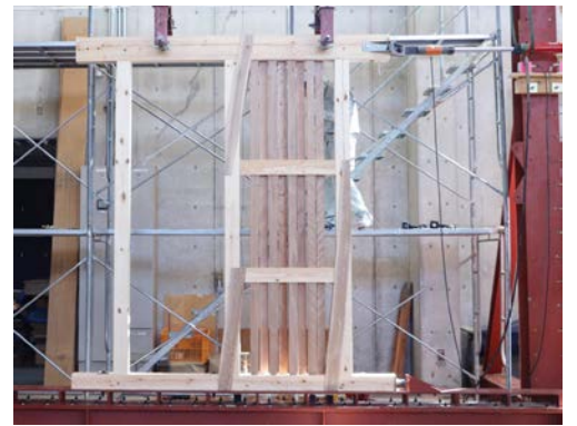
5トンの負荷をかけても壊れない耐力壁「一位の壁」
