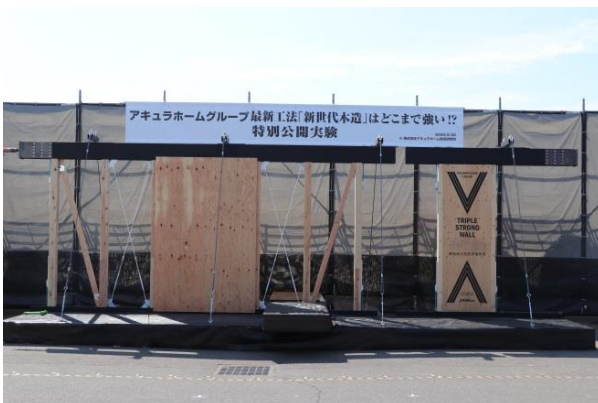
「一般的な耐力壁6枚」(写真左・左側)と「トリプルストロングウォール1枚」(写真左・右側)の2種類の試験体を、それぞれの壁が破壊されるまで重機で水平方向に引っ張り強度を比較
