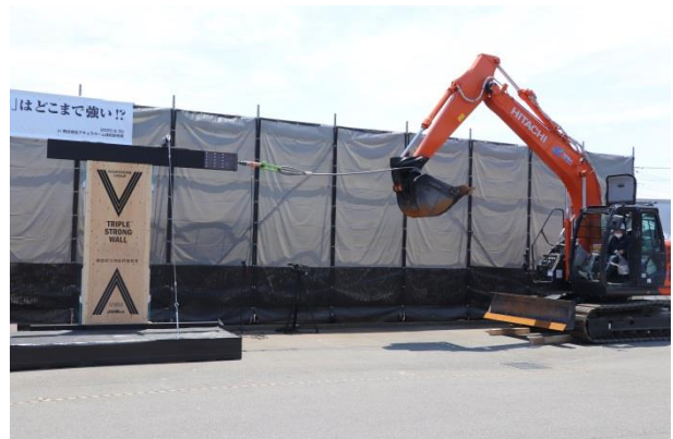
「一般的な耐力壁6枚」(写真左・左側)と「トリプルストロングウォール1枚」(写真左・右側)の2種類の試験体を、それぞれの壁が破壊されるまで重機で水平方向に引っ張り強度を比較
