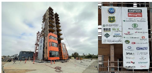
世界的リーディングカンパニーも参画した世界最大の「10階建て木造ビル耐震実験」
