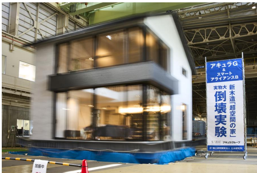
想定・首都直下型地震など震度7クラスの地震波に耐える様子
