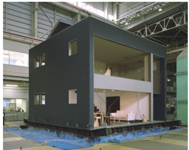
これだけ開口部を大きく取った住宅での耐震実験はこれまでに例がありません。 写真データは下記 URL よりダウンロードできます URL : http://www.aqura.co.jp/news.html
